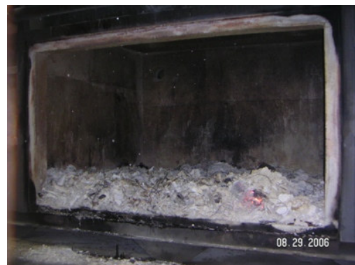
la "cenere bianca" risultante dal processo, che include metalli e vetro nello stato e forma originali, e soltanto il 3% dei composti carboniosi originali
